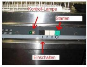
Nach Beendigung aller Spülgänge wird die Maschine wieder über den schwarzen Knopf ausgeschaltet und der Überlaufstopfen im Inneren der Maschine muss wieder entfernt werden.
